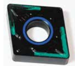
Insert after operation with one edge Platte nach der Bearbeitung mit einer Schneidecke
